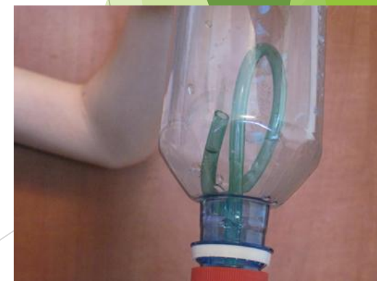
Конструкция чаша Тантала
