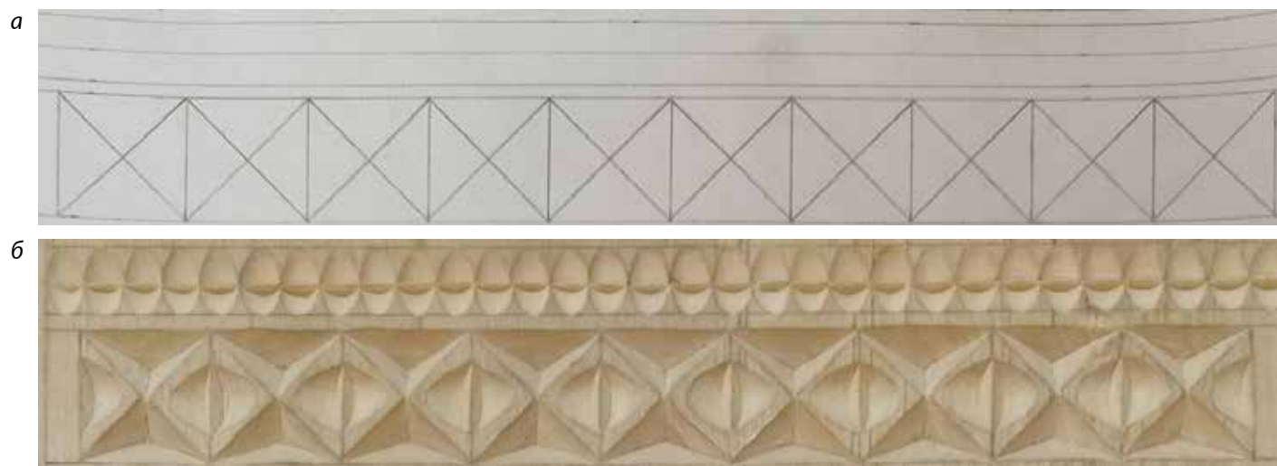
Рисунок 4. Упражнения для обучения работе со стамесками и штихелями а – схема разметки, б – доска-образец
