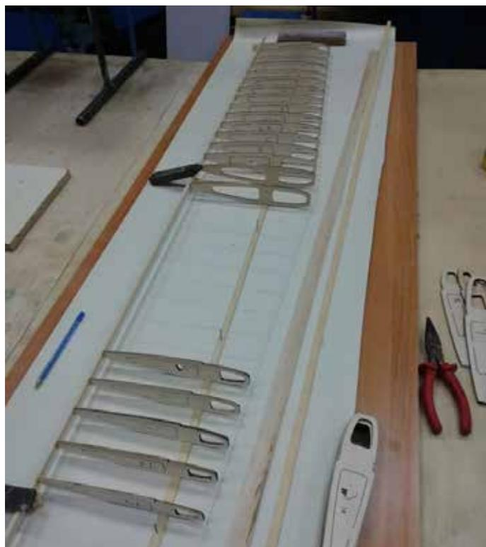
*Рис. 7. Сборка крыла*
