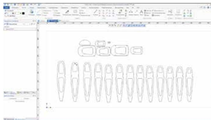
Рис. 3. Построение нервюр и шпангоутов на компьютере
