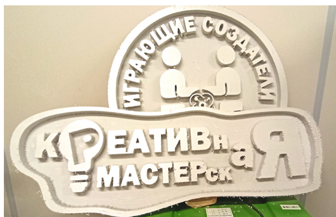
Фото 2. Эмблема проекта, выполненная из пенополиуретана на фрезерном станке с ЧПУ
