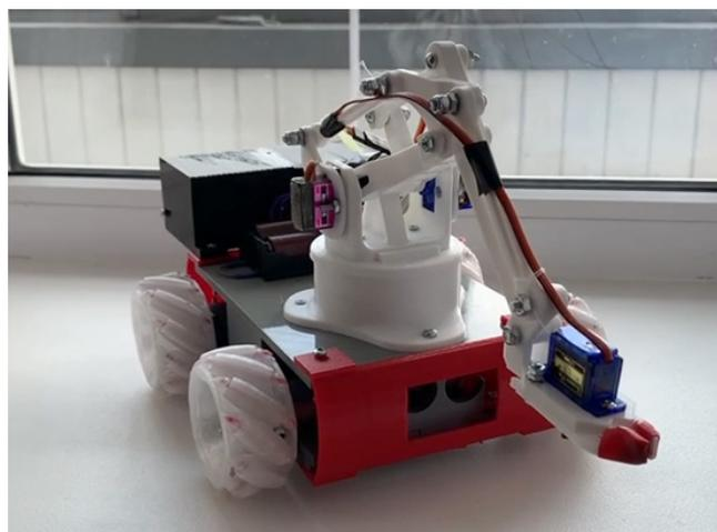
Рис. 8. Прототип робота-манипулятора
