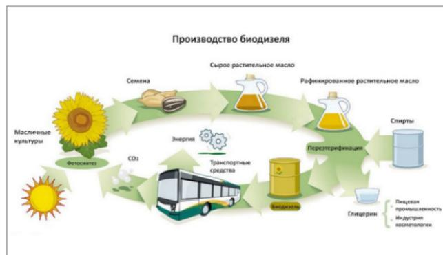
Рис. 6. Технология получения биодизеля
