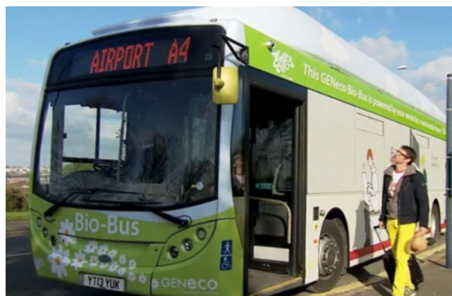
Рис. 3. Автобус на биогазе (биометане)
